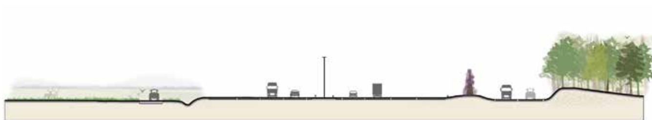
Geluidscherm tussen randweg en A58 en verdiepte randweg l.h.v. 19 HMP
