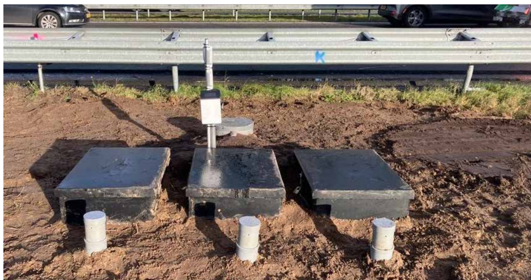
Het water van de snelweg wordt op drie dieptes gemeten (Foto: Rijkswaterstaat/InnovA58)
