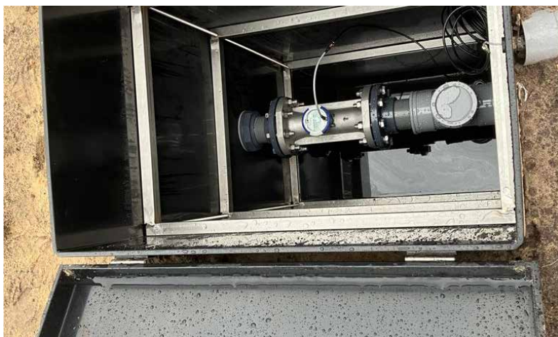
Het instrument waarmee het debiet wordt gemeten. Er worden ook monsters genomen om de waterkwaliteit te onderzoeken (Foto: Rijkswaterstaat/InnovA58)
